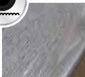
**Microriffelung:** Durch sehr fein gezackte Hobelmesser entsteht eine geriffelte Oberfläche, die eine gleichmäßigere und höhere Farbaufnahme von Dünnschichtlasuren ermöglicht.
