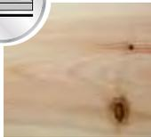
**Gehobelte Oberfläche:** Auf rotierenden Walzen sorgen präzise eingestellte Hobelmesser aus Spezialstählen dafür, dass eine absolut gerade und glatte Oberfläche in der gewünschten Form entsteht.
